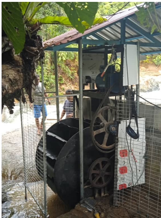
Fig. 4: Mini Hydro Turbine System Installation
