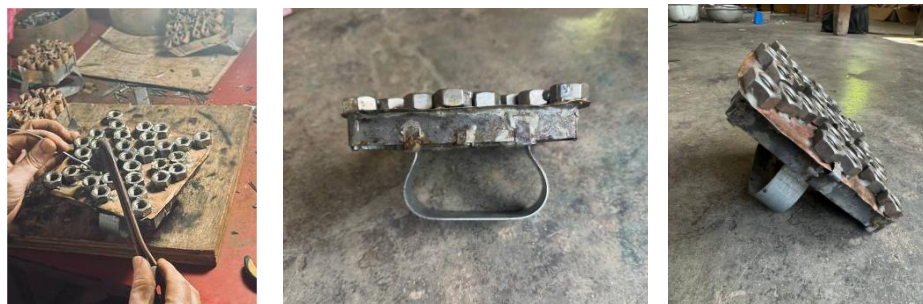
Gambar 6: Kaedah pateri yang dilakukan (Sumber: Penyelidik )
