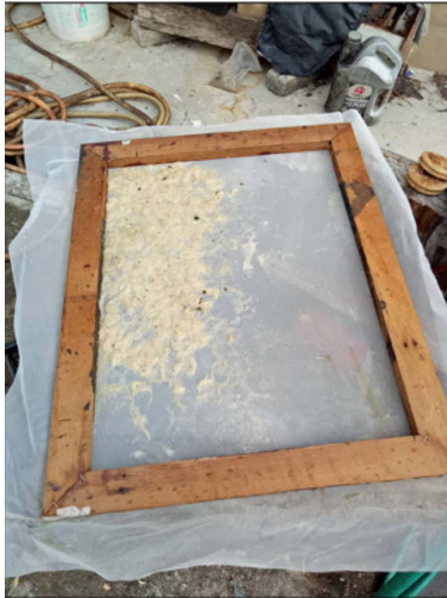
Rajah 6: Serat kenaf diletakkan di atas kain surih sebelum ditekan dengan menggunakan tangan bagi mengeluarkan air
